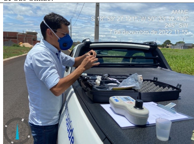
Autor: AMAE Descrição: Equipe da AMAE realizando análises de qualidade da água (turbidez e cloro) distribuída a população.
